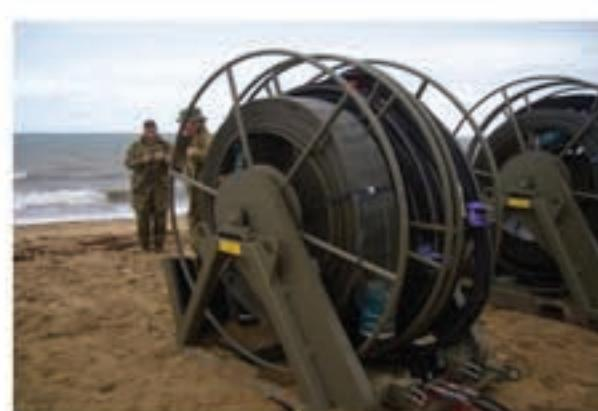
При перекачке бензина используются рукавные трубопроводы с интегрированной в оболочке шиной заземления.
